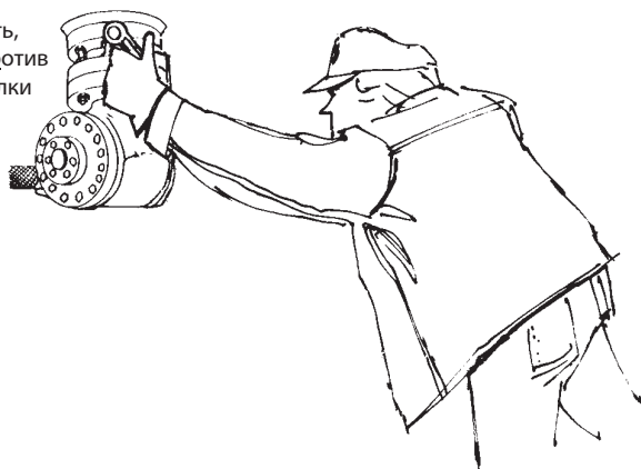
Рисунок 9. Приведение в действие фланцевого клапана Flomatic® вручную
